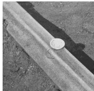
Knallsignal av den sort som stoppade snälltåget. För att inte blåsa bort, klämdes den som synes fast vid rälsen.
